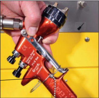
トリガーロックスプリングが正しい位置にある
