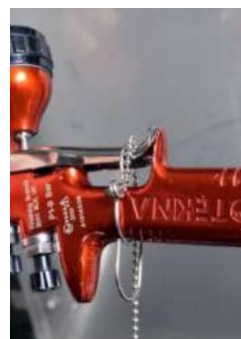
スプレーガンへのトリガー ロックスプリングの取り 付け
