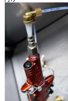
スプレーガンへのトリガー ロックスプリングの取り 付け
