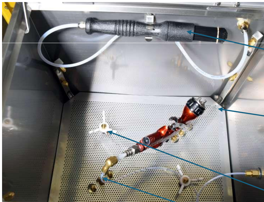
タンク内に設置されたスプレーガン
