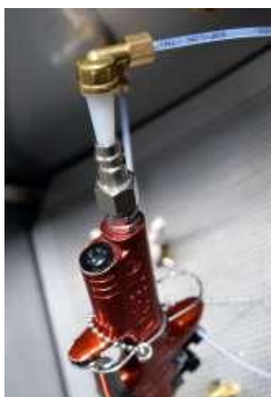
スプレーガンのエア通路に挿入されたエアプラグ
