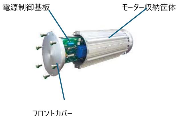
フロントカバーに取り付けられた6本のネジを緩め、モーター収納筐体から均等に慎重に引き外してください。これによりヒューズが露出します
